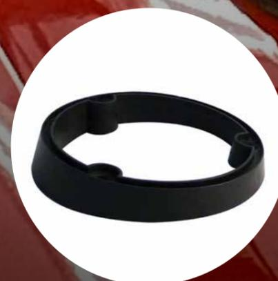
L'anello di fissaggio (Art. D14512) è un utile complemento per montare in modo sicuro i lampeggianti della serie ZL-700 della gamma TRALERT®. Progettato specificamente per i lampeggianti con un diametro di 130 mm, garantisce un montaggio stabile su superfici con angoli da 3° a 6°. Grazie alla robustezza del materiale, il D14512 è in grado di resistere ad ogni condizione atmosferica.
