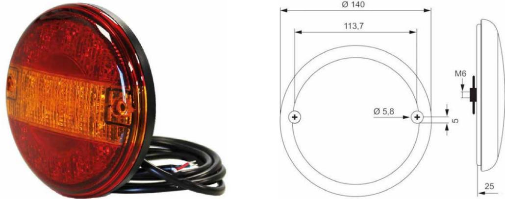
Die bekannte Hamburger-Lampe im schlankeren Design: das ist die VC-140 von TRALERT®. Dadurch kann das bekannte Hamburgerlicht auch bei wenig Platz montiert werden. Mit nur 25 mm Höhe ist dieses häufig verwendete LED-Trailerlicht ideal für die Montage an der Rückseite Ihres landwirtschaftlichen Fahrzeugs oder Ihrer Erdbewegungsmaschine.
