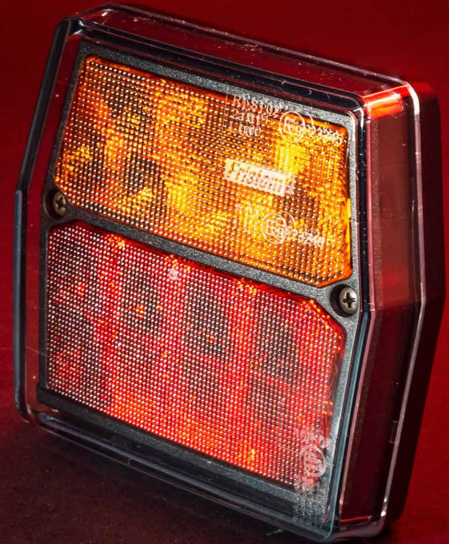
LED-RÜCKLEUCHTE MIT DYNAMISCHEM BLINKLICHT
